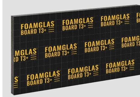
FOAMGLAS® BOARD T3+ bestehen aus verklebten FOAMGLAS® T3+ Platten, die oberseitig mit einer Verbund-Kaschierung aus Spezialglas-vlies und PE-Folie versehen sind und unterseitig mit Spezialglasvlies. Die oberseitige Kaschierung ist gelb, auf der Unterseite befindet sich ein weißes Vlies.
