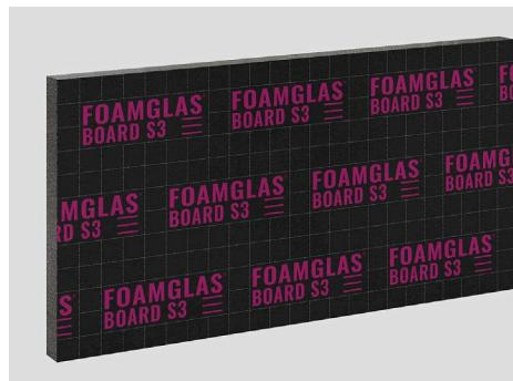
FOAMGLAS® BOARD S3 bestehen aus verklebten FOAMGLAS® S3 Platten, die beidseitig mit einem Spezialglasvlies kaschiert sind. Die oberseitige Kaschierung ist violett, auf der Unterseite befindet sich ein weisses Vlies.
