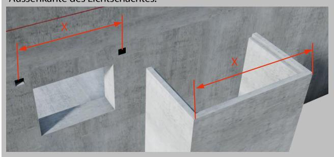
Einhängen des BKA Pro Schachtfix und **Mass H messen** bis zum geplanten OK Terrain.
