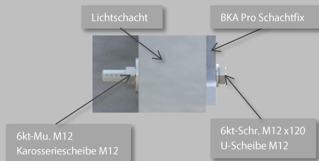
Den Lichtschacht einhängen an geplantes OK Terrain und ausrichten. **Mit Schrauben festziehen.**
