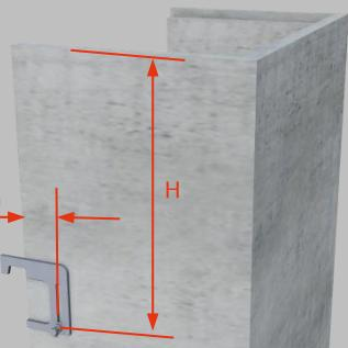
Um Abplatzungen zu vermeiden, wird empfohlen die Löcher vom Schachtinnern nach aussen zu bohren und auf der Gegenseite ein Holz mit Schraubzwinge zu fixieren.
