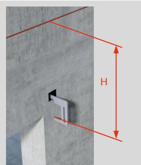
Abtragen des **Masses H** von OK Lichtschacht bis Mitte Bohrloch und **Bohrloch Ø12 mm** bohren.
