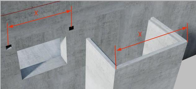
Einhängen des BKA Pro Schachtfix und **Mass H messen** bis zum geplanten OK Terrain.
